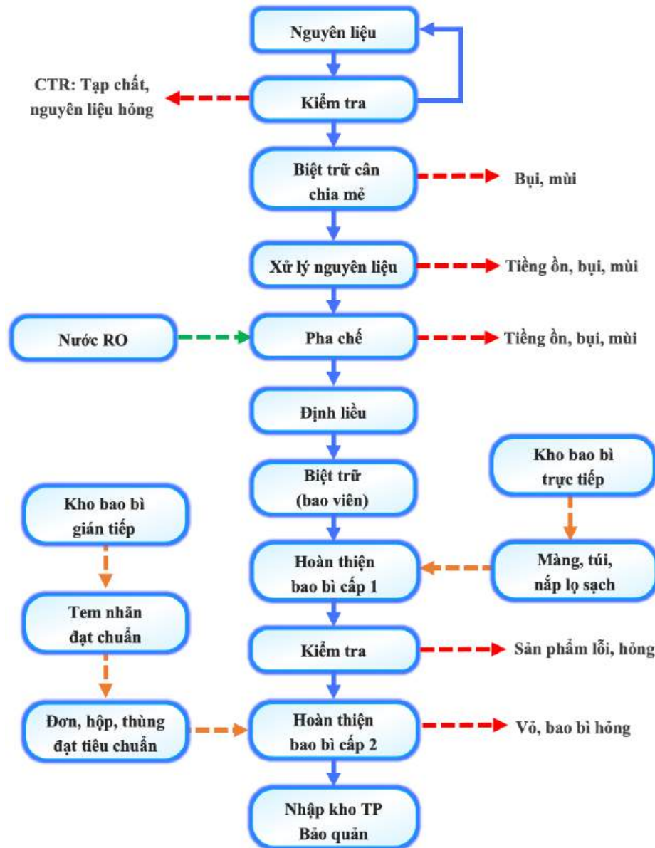
Hình 1.3: Sơ đồ quy trình công nghệ sản xuất BTP – TP thực phẩm bảo vệ sức khỏe, thực phẩm bổ sung, thực phẩm
