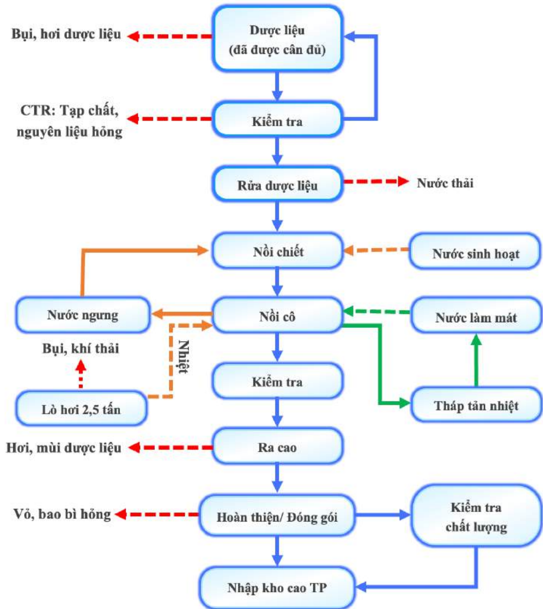
Hình 1.2: Sơ đồ quy trình công nghệ chiết xuất cao dược liệu.
