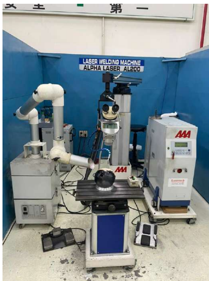
Hình 3-7: Khu vực hàn kèm hệ thống xử lý khói hàn của nhà máy
