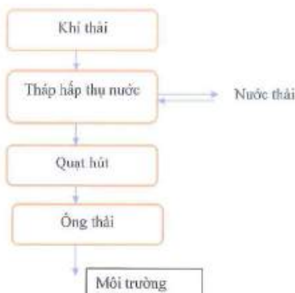
Hình 8. Sơ đồ công nghệ hệ thống xử lý khí thải mạ 01
