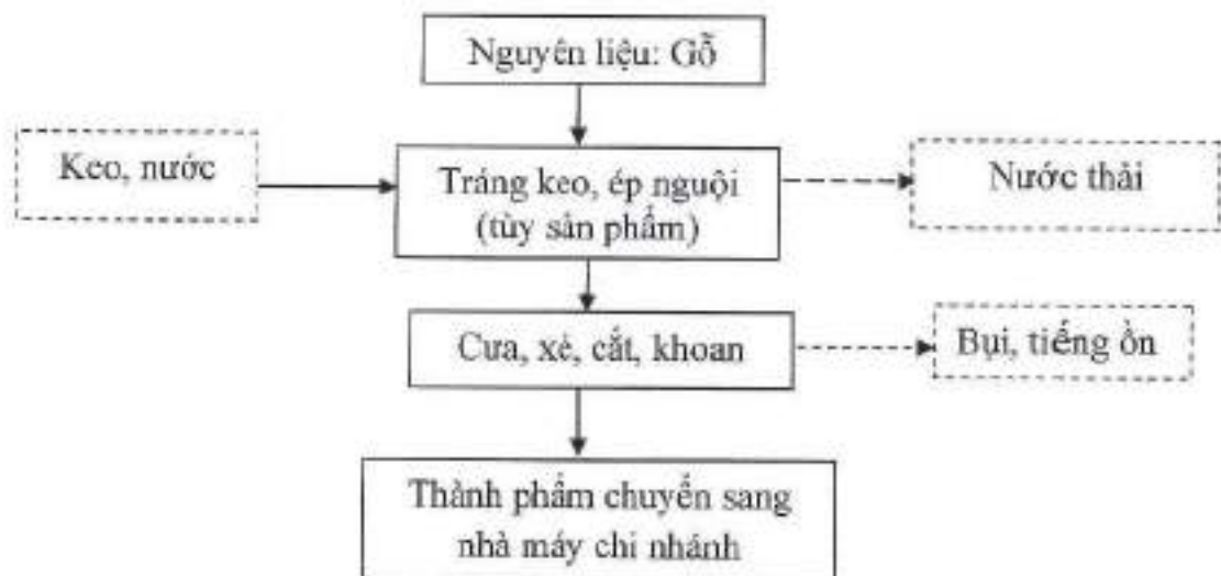
Hình 8 Quy trình sản xuất khung sofa
